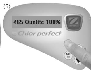
4. Maintenir la touche « CAL/Enter » appuyée pendant 5 secondes jusqu'à l'affichage du mot « Calibrage » sur l'écran LCD (4a). Presser de nouveau la touche « CAL/Enter » comme indiqué sur l'écran pour lancer le calibrage sur 465 mV (4b).
